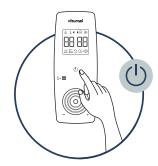
온도설정 버튼을 눌러 원하는 온도를 설정해주세요. Press the temperature setting button to set the desired temperature ※ 온도설정범위: 25~45℃
